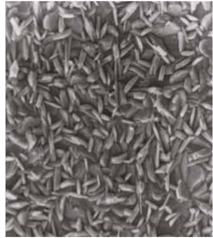
Kaplama oluşumu: Çinko fosfat öncesi Aktivasyonun kaplamaya etkisi,
