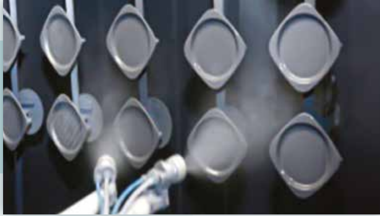
Şekil 7. Manuel sprej emayeleme yöntemi uygulaması
