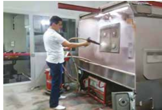
Şekil 5. Elektrostatik toz emaye uygulaması (Artel Özbekistan emaye tesisi, 2015)
