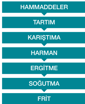
Şekil 2. Frit üretimi akış şeması (Algotrio) Figure 2. Frit production flow chart (Algotrio)
