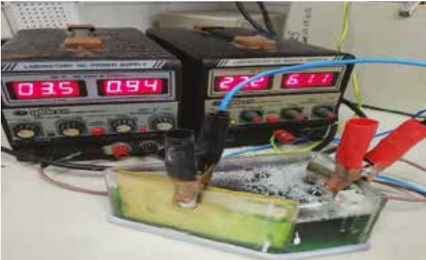
Şekil 4. Hull cell test yöntemi ekipmanları (redresör, hull cell kabı, pirinç plaka, bağlantı kabloları)
