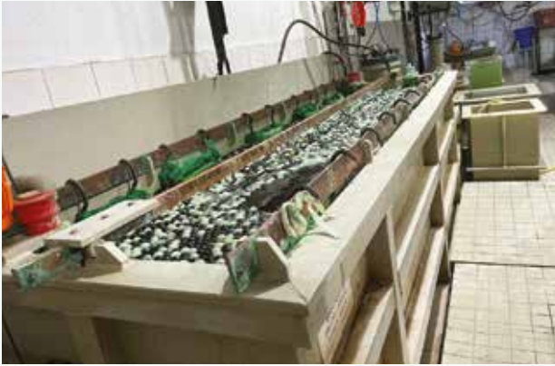
Askı Nikel Kaplama Hattı Hanger Nickel Plating Line
