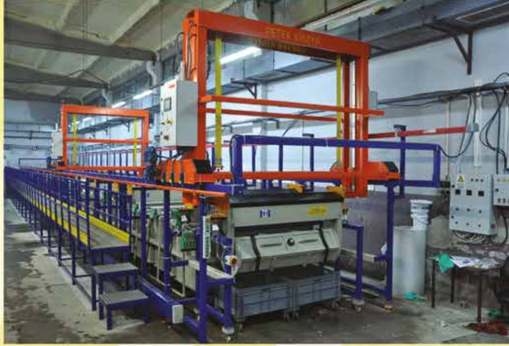
Tam Otomatik Tambur Kaplama Tesisi
