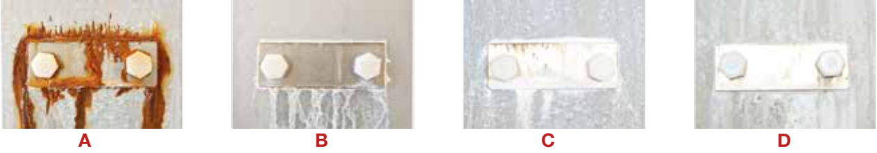
Resim 2: Tuz püskürtme testinden 1200 saat sonra elde edilen sonuçlar. Büyük plaka çinko lamel ile kaplanmıştır, küçük plaka temas ortağıdır. Bazkatlı çinko lamel + paslanmaz çelik (A), bazkatlı ve sonkatlı çinko lamel + paslanmaz çelik (B), bazkatlı çinko lamel + alüminyum (C), bazkatlı ve sonkatlı çinko lamel + alüminyum (D)
