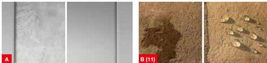
Şekil.6 - Kir ve su tutmaz mimari malzemelerde sol-jel kaplamalar, a) Cam (Kaplanmış (sağ) ve kaplanmamış (sol)) mimari camlarda kireç lekeli oluşumu ve b) Su tutmaz gözenekli doğal taş (Ahlar Taşı) (11).
